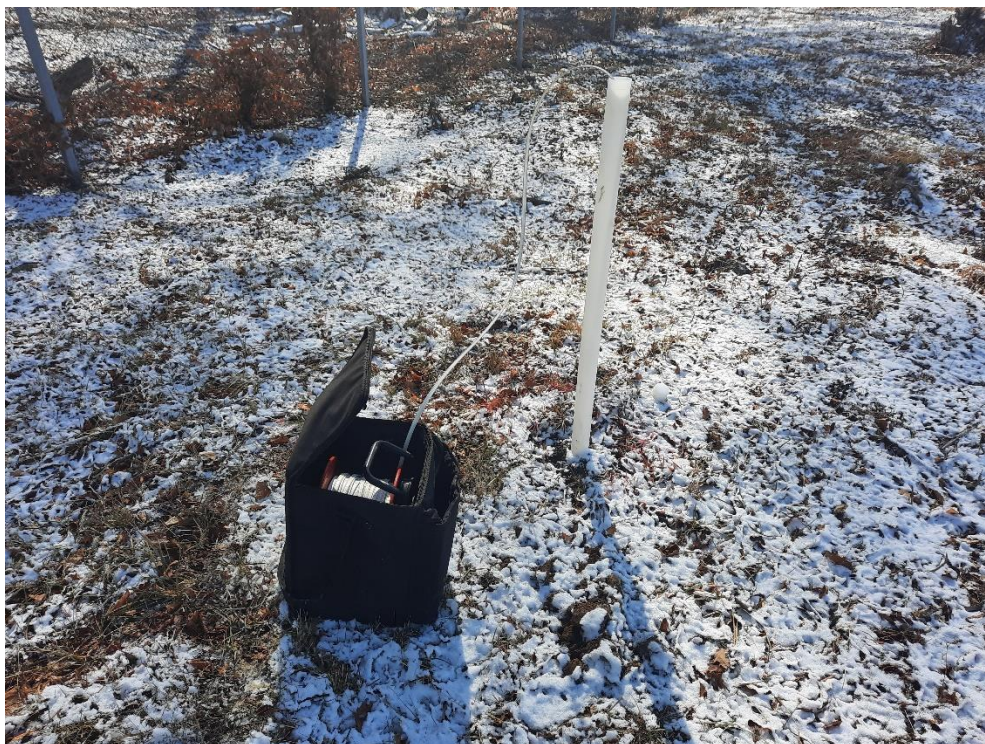
Figur 9. Foto på inmätning av grundvattennivån i provpunkt 22M010. Foto taget 220405.
