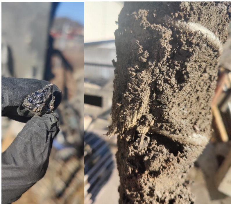
Figur 11. Slagg som påträffades i prov 22M004-2 (t.v.) och trä som påträffades i prov 22M005-8 (t.h.).
