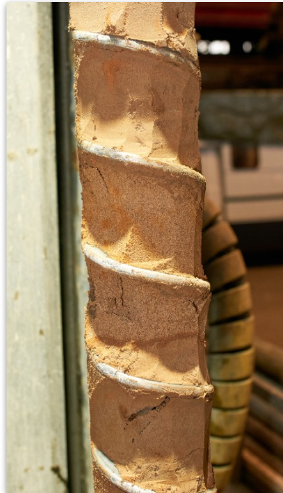
Figur B2-1. Provpunkt LA 05. Till vänster i bild fyllning nivå ca 0,2 - 0,6 mumy, till höger varierande naturlig finsand och mellansand på nivå omkring ca 3 mumy.
