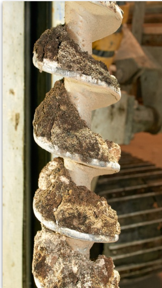
Figur B2-1. Provpunkt LA 05. Till vänster i bild fyllning nivå ca 0,2 - 0,6 mumy, till höger varierande naturlig finsand och mellansand på nivå omkring ca 3 mumy.
