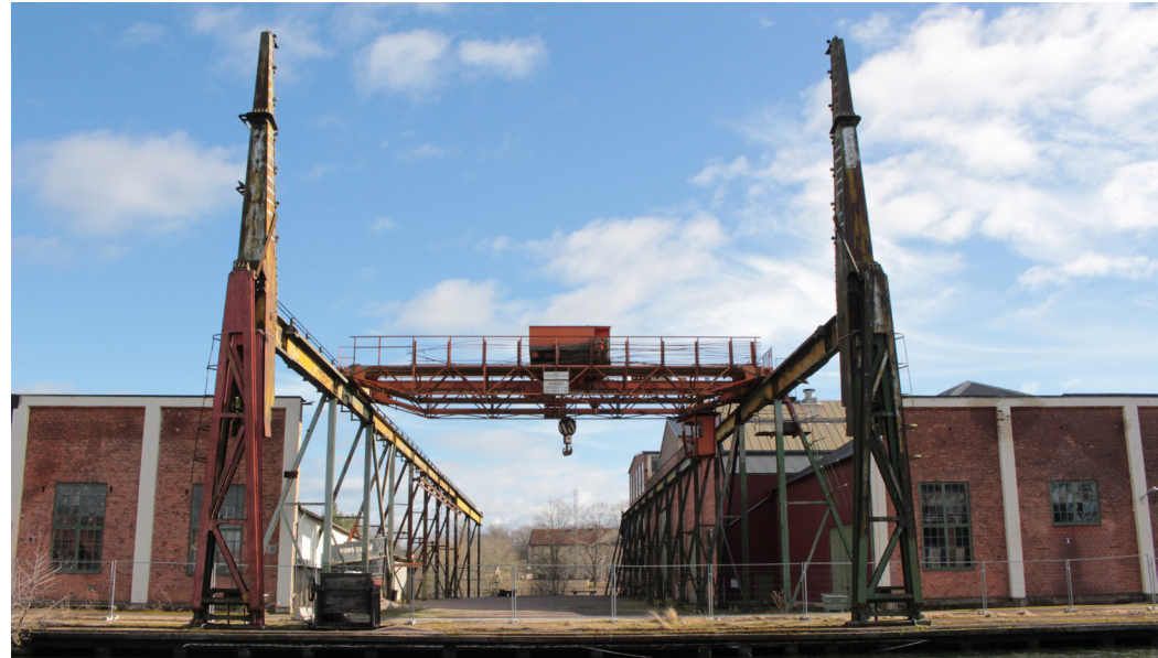
Den karaktärskapande traversen ger en bild av den tunga gods försörjningen till verkstaden.
