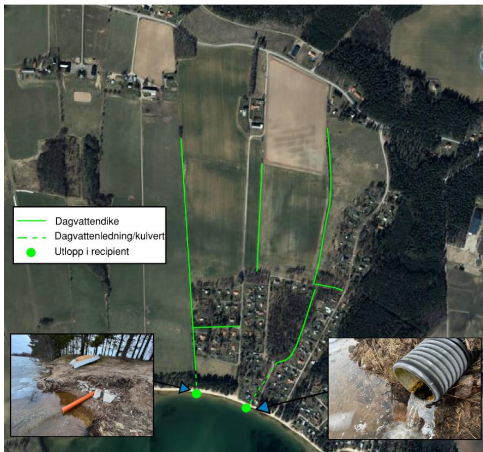
Figur 13. Beskrivning av befintlig dagvattenhantering inom planområdet, med markerade diken, kulvertar och utlopp. Foton på utlopp är tagna vid platsbesök utfört i februari 2024.
