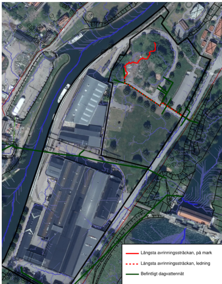
Figur 16. Kombination av avrinningskarta och karta över befintligt ledningsnät, med dimensionerande avrinningssträcka för Motala Verkstad 2 markerad i rött. Totalt utredningsområde markerat som svart, heldragen linje.
