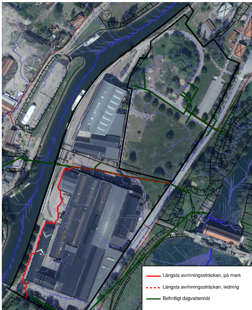
Figur 15. Kombination av avrinningskarta och karta över befintligt ledningsnät, med dimensionerande Avrinningssträcka för Motala Verkstad 1 markerad i rött. Totalt utredningsområde markerat som svart, heldragen linje.
