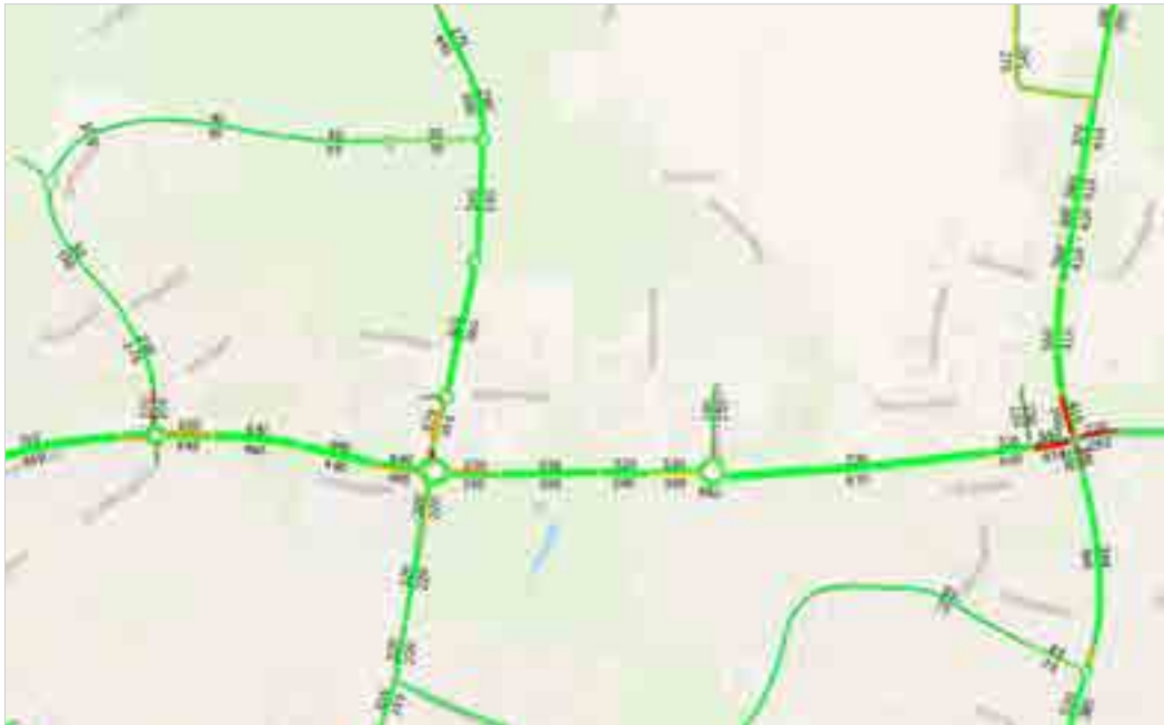
Figur 28: Simulerad framkomlighet i de mest belastade delarna, färgkodad, och flöde i antal i fordon per timme i prognos fullständig exploatering enligt ÖP (5 000 nya bostäder) under förmiddagens maxtimme som ett genomsnitt för perioden kl 07:00-08:00
