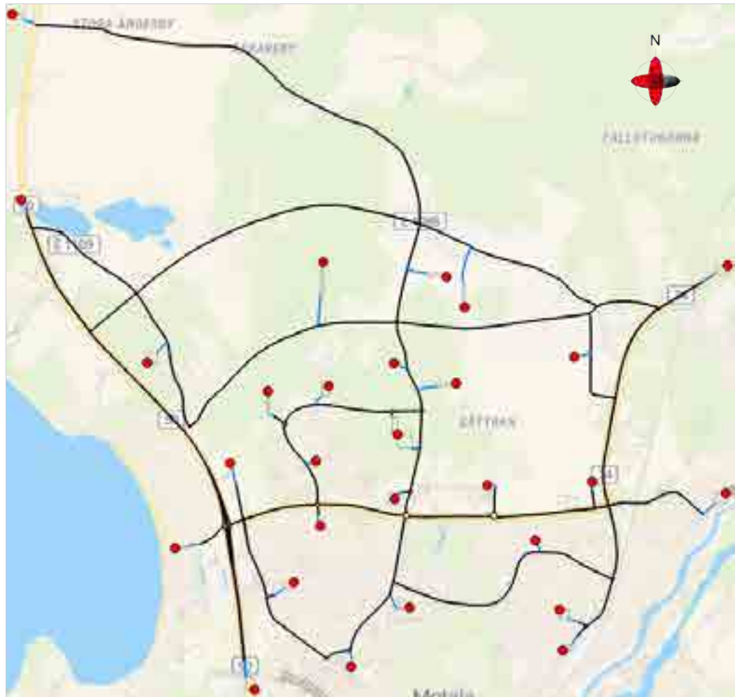
Figur 17. Modellen över prognosscenarierna med framtida vägnät i svart och trafikens simulerade start- och målpunkter i rött där även tillkommande bostadsbebyggelse inkluderats.
