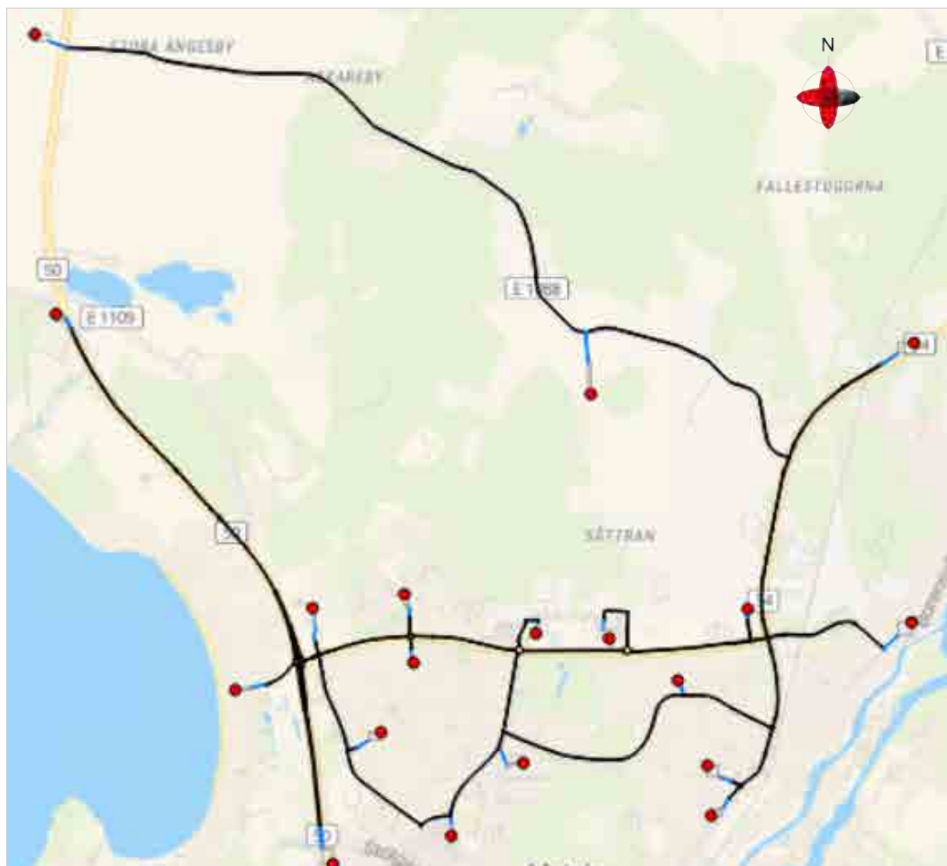
Figur 12. Modellområde för den simuleringsmodell i Dymeq som tagits fram för nuläget. Vägnätet i svart och trafikens start- och målpunkter i rött.
