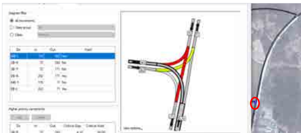
Figur 19. Detalkodning av tillkommande korsning längs väg 34 med stopplikt från den lokala anslutningen och separat ficka för vänstervängande från väg 34.
