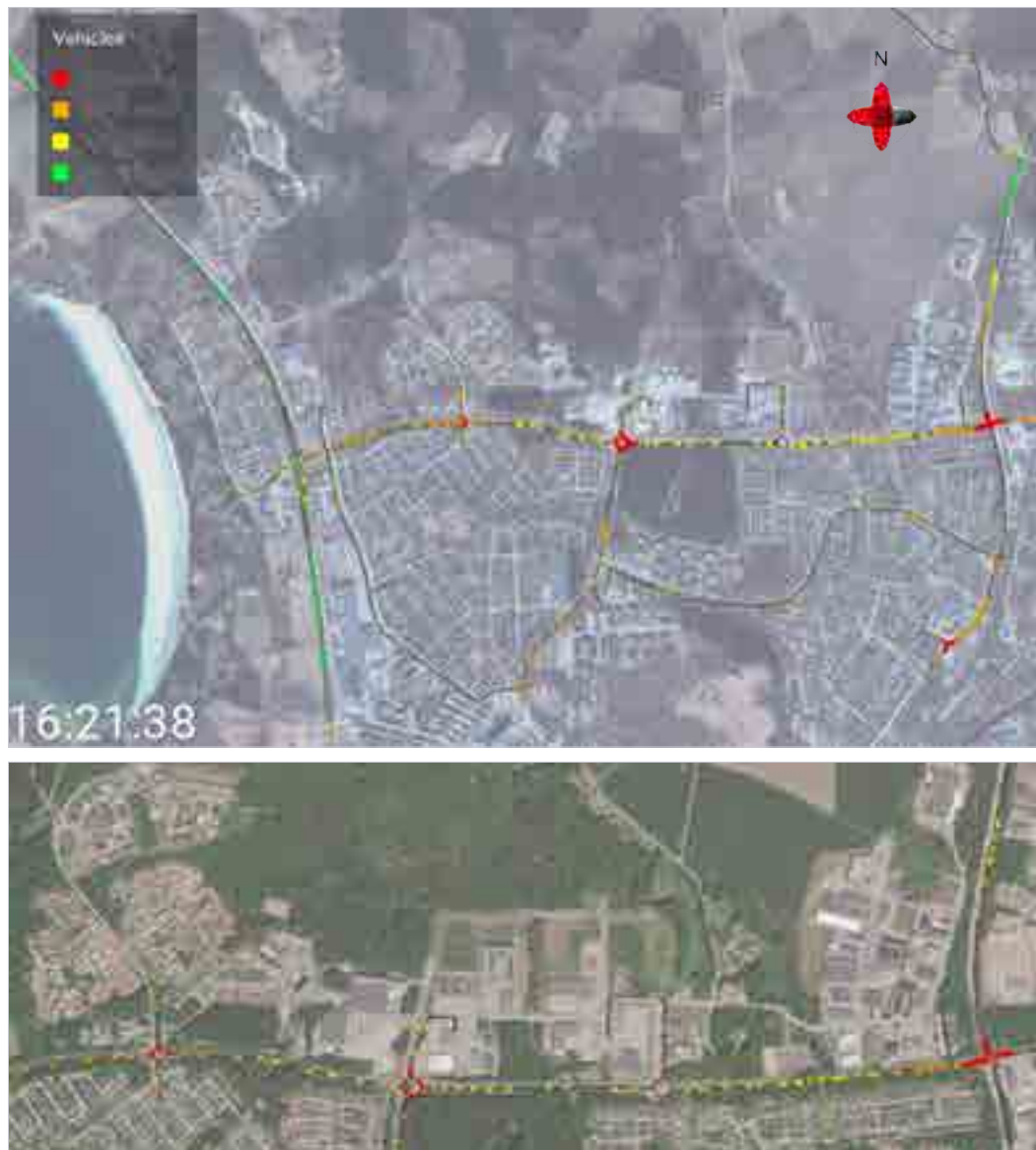
Figur 13. Ögonblicksbild från simuleringen av nuläget under eftermiddagsrusningen. Enskilda fordon rör sig genom vägnätet och deras hastighet visualiseras med färgkodning.
