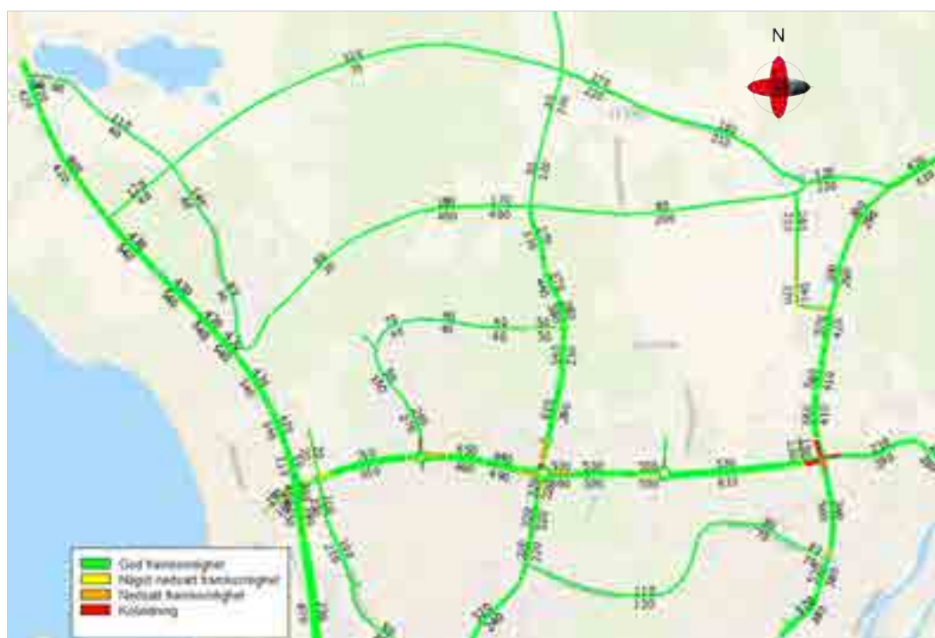
Figur 27. Simulerad framkomlighet, färgkodat, och flöde i antal i fordon per timme i prognos fullständig exploatering enligt ÖP (5 000 nya bostäder) under förmiddagens maxtimme som ett genomsnitt för perioden kl 07:00-08:00
