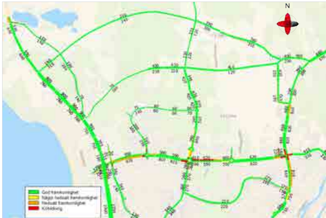
Figur 29. Simulerad framkomlighet, färgkodat, och flöde i antal i fordon per timme i prognos fullständig exploatering enligt ÖP (5 000 nya bostäder) under eftermiddagens maxtimme som ett genomsnitt för perioden kl 16:00-17:00.
