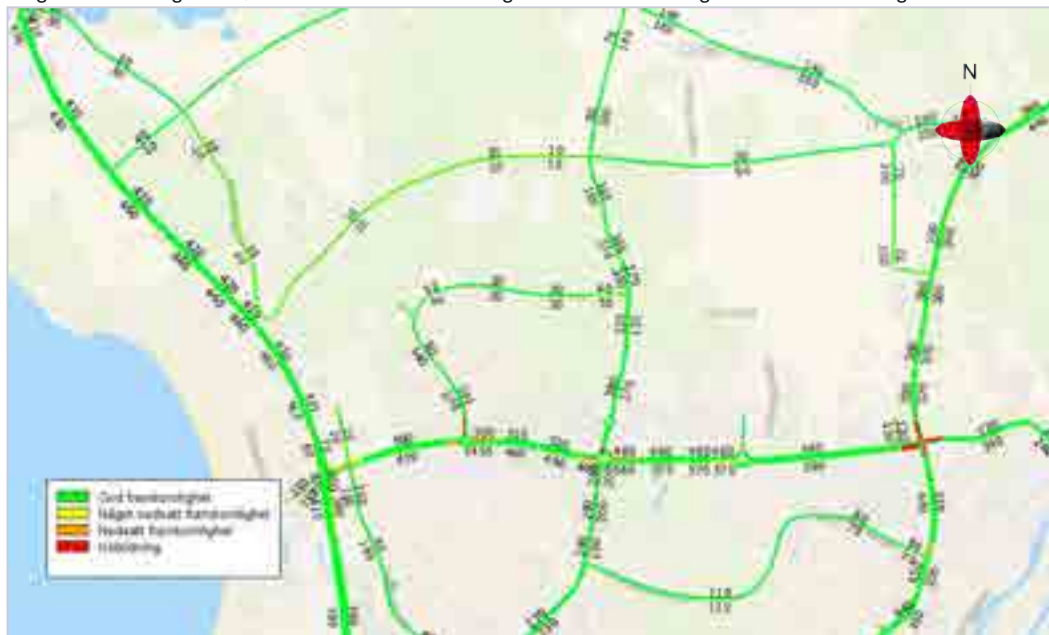
Figur 23. Simulerad framkomlighet, färgkodad, och flöde i antal i fordon per timme för prognos etapp 2,3,4 (2 500 nya bostäder), förmiddagens maxtimme i genomsnitt kl 07:00-08:00
