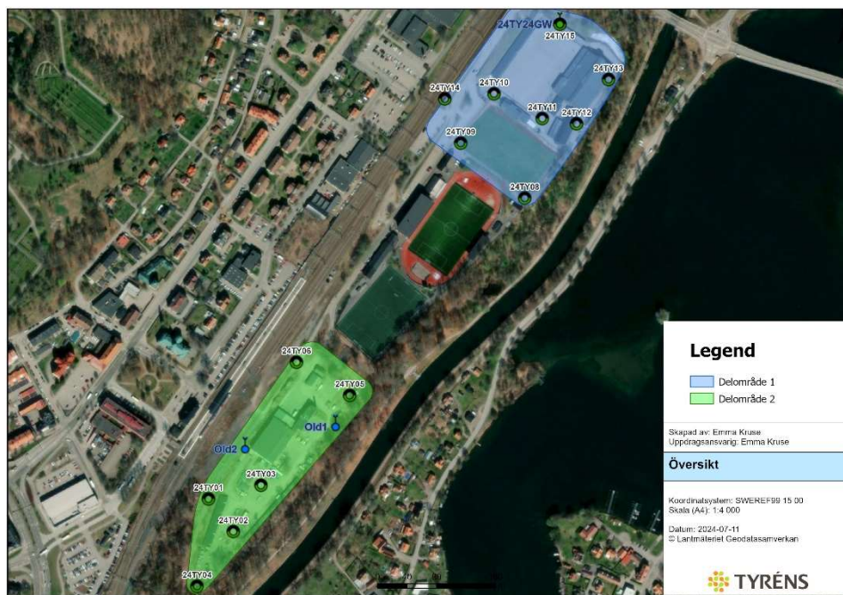
Figur 1. Översiktskarta med nu utförda borrpunkter och installerade grundvattenrör, äldre grundvattenrör samt delområden.
