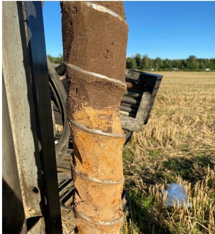
Figur 6. Foto på provtagningskruv med jordartsbyte.
