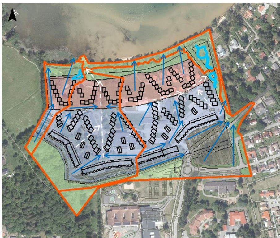
Figur 20. Förslag på sekundära avrinningsvägar (vita streckade pilar) vid ett 100-årsregn när dagvattensystemets kapacitet är överstigen. Blå heldragna pilar visar på flödesriktning.
