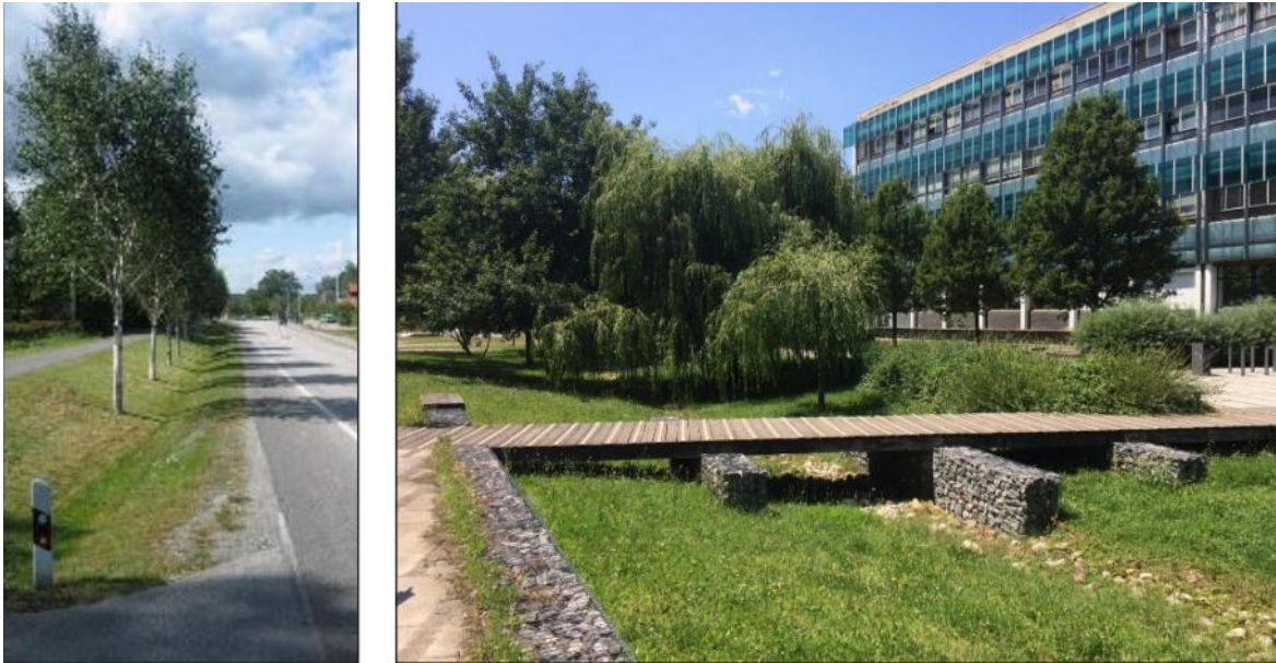
Figur 13.4-1 Exempel på svackdike (Bildkälla: Svenskt Vatten, 2019).
