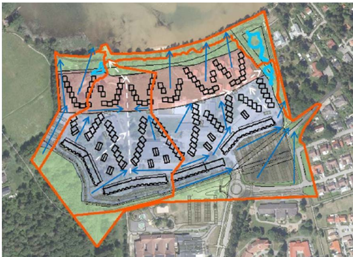
Figur 11. Alternativ 1, förslag på sekundära avrinningsvägar (vita streckade pilar) vid ett 100-årsregn när dagvattensystemets kapacitet är överstigen. Blå heldragna pilar visar på flödesriktning. Källa: Afry.
